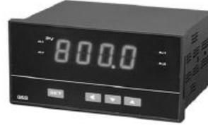
说明：仪表上电后，仪表显示窗口 PV 显示测量值。输入的测量信号超出量程时（如热电偶短线），则显示窗显示 “orAL”。
